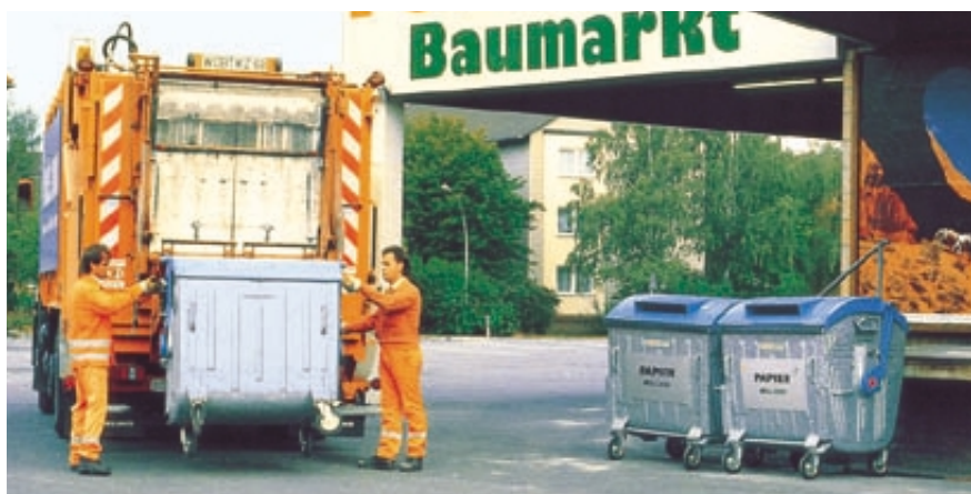
MGB horganyzott kivitelben, nyílásfedővel
