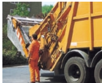
Űrités emelő-borító rendszerrel
