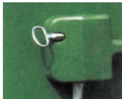
Háromszögár a fék rögzítésére
