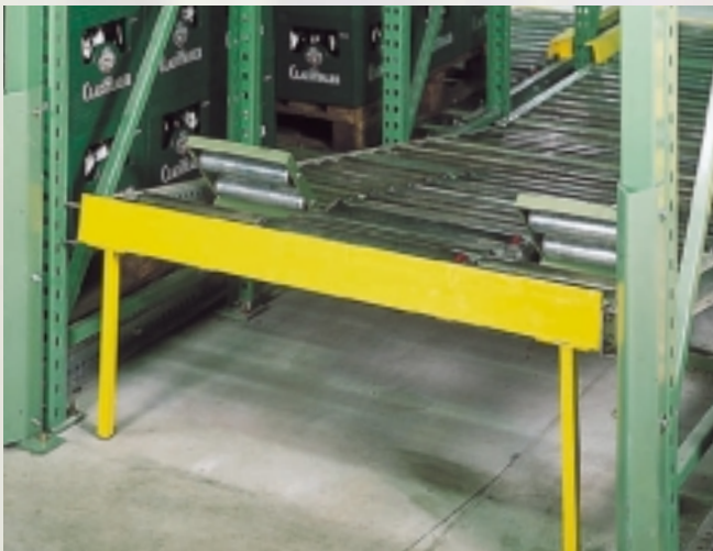
Igény esetén a szállítópályák vége felhajtható kivitelben készül, hogy könnyebb legyen a takarítás a kitárolási oldalon
