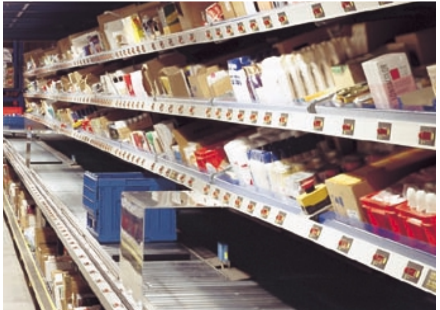
Utólag egyszerűen felszerelhető – „Pick-by-Light” egy kozmetikai cikket kommissiózó raktárban
