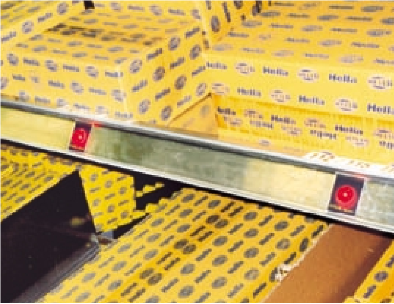
„Pick-by-Light” számítógépezérelt kommissiózás
