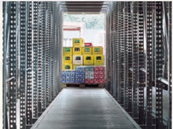
Keresztirányú raklapszállítás, csatornamélység 24 000 mm
