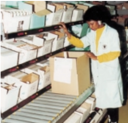
Villogó LED-kijelzők irányítják a kiemelést
