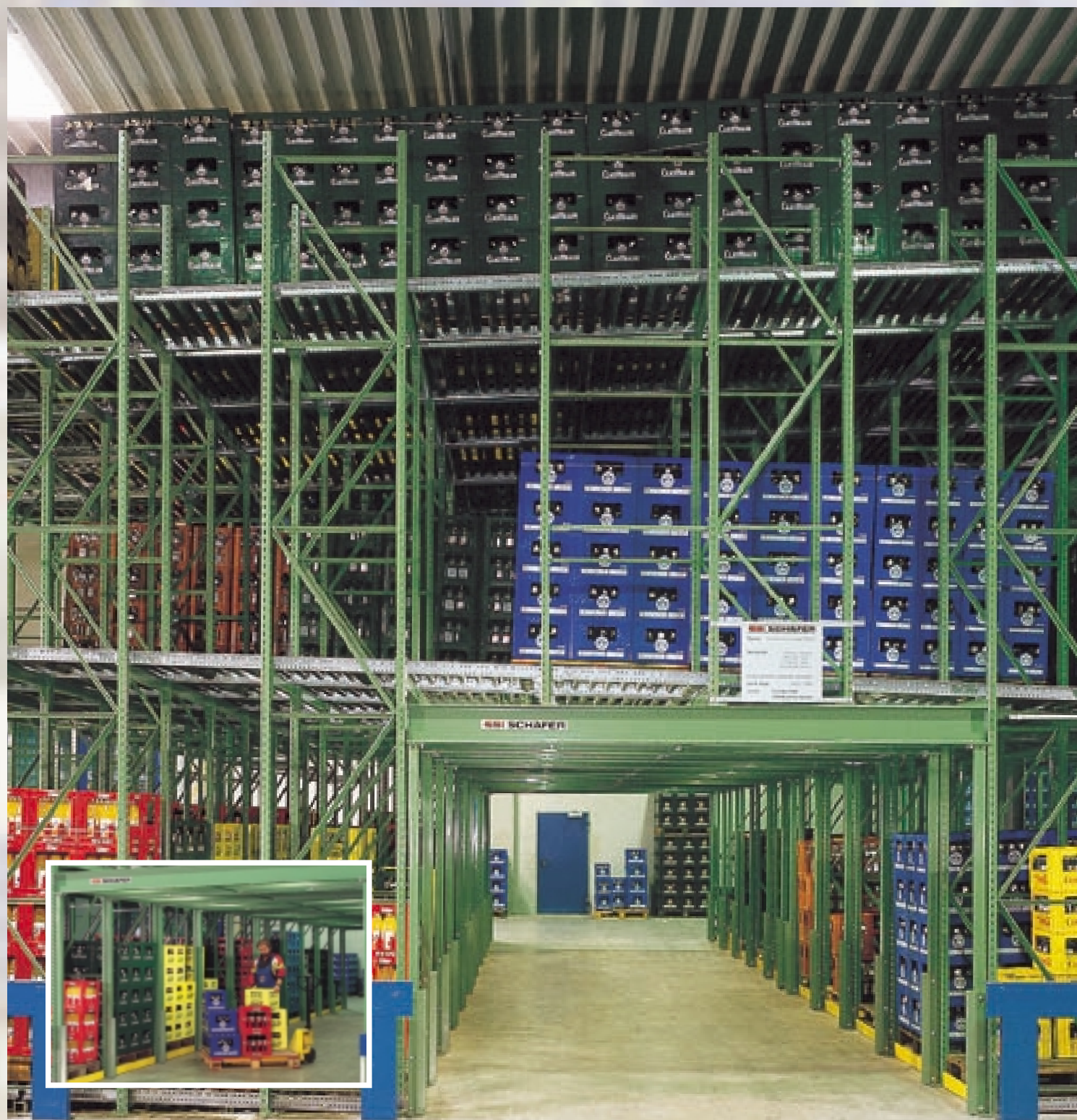
Kommissiózó alagút egy sörgyárban. Az első szint a kommissiózás szintje. A kézi kiszedés rekeszenként történik. A raklapok mérete különböző, és a rakomány nincs rajtuk rögzítve. Óvatos fékezést biztosít a beépített dinamikus fékberendezés. A szállítópályák vége felhajtható, hogy könnyebb legyen a takarítás a kommissiózó oldalon.
