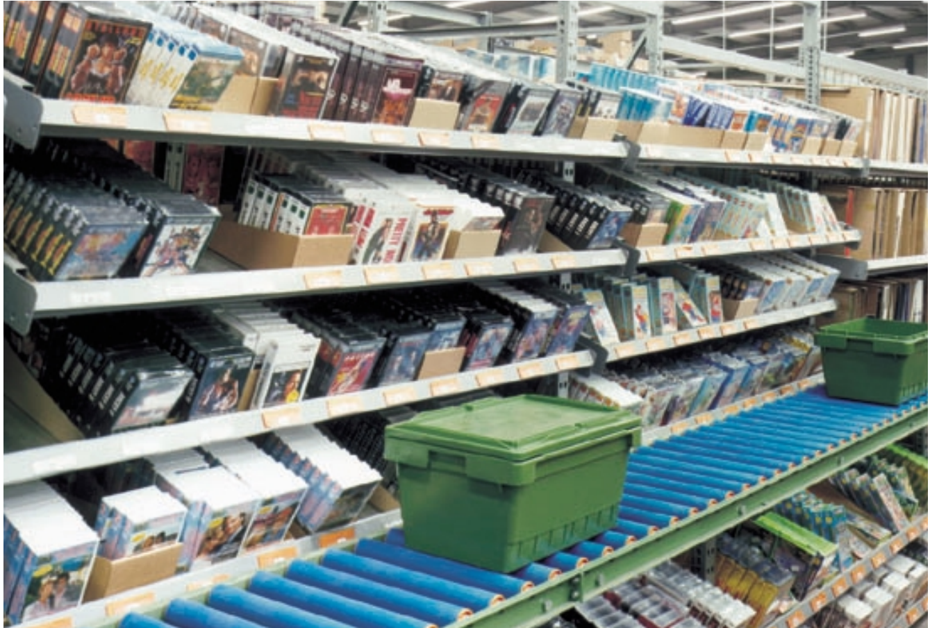
DR 20-as állványrendszer egy kép- és hanghordozókat forgalmazó cég elosztó központjában
