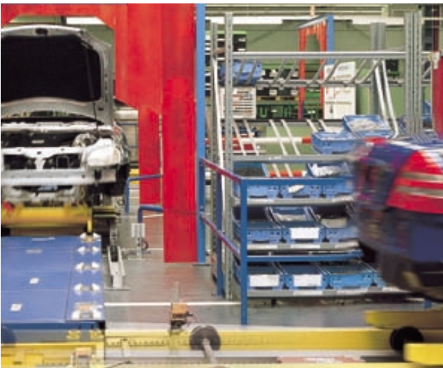
Az igényeknek megfelelő anyagelőkészítés közvetlenül a szerelősor mellett
