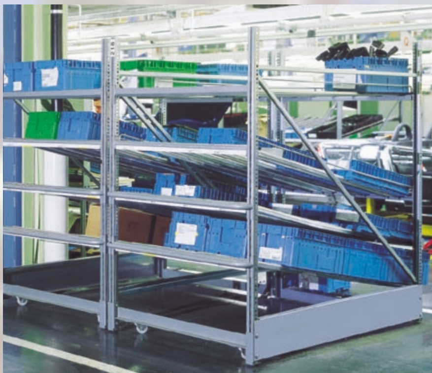
A fenekeén megvezetőhornokkal ellátott KLT-doboz különösen jól használható a csúsztató pályával ellátott R 7000 előkészítő szerelőállványhoz
