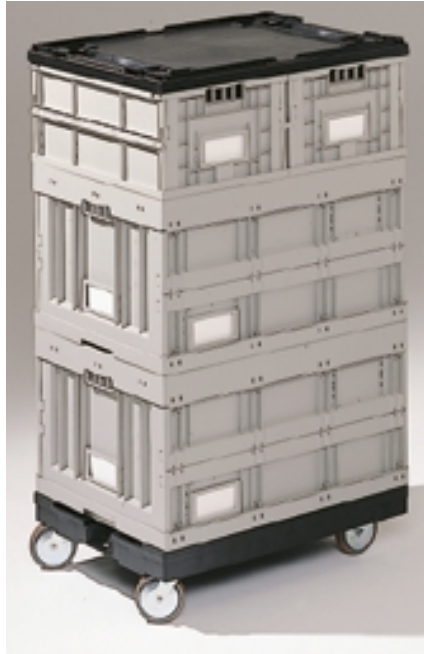
Görgős raklap 2 fix és 2 elforduló kerékkel – \varnothing 125 mm; alsó perem alatti magasság 115 mm; terhelhetőség 450 kg-ig
