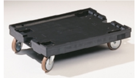
Görgős raklap 2 fix és 2 elforduló kerékkel – \varnothing 125 mm; alsó perem alatti magasság 115 mm; terhelhetőség 450 kg-ig
