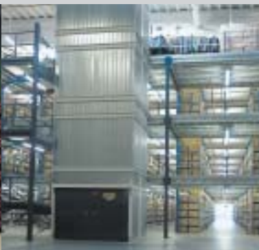
Raktári galériák és állványra épített járőfelületek
