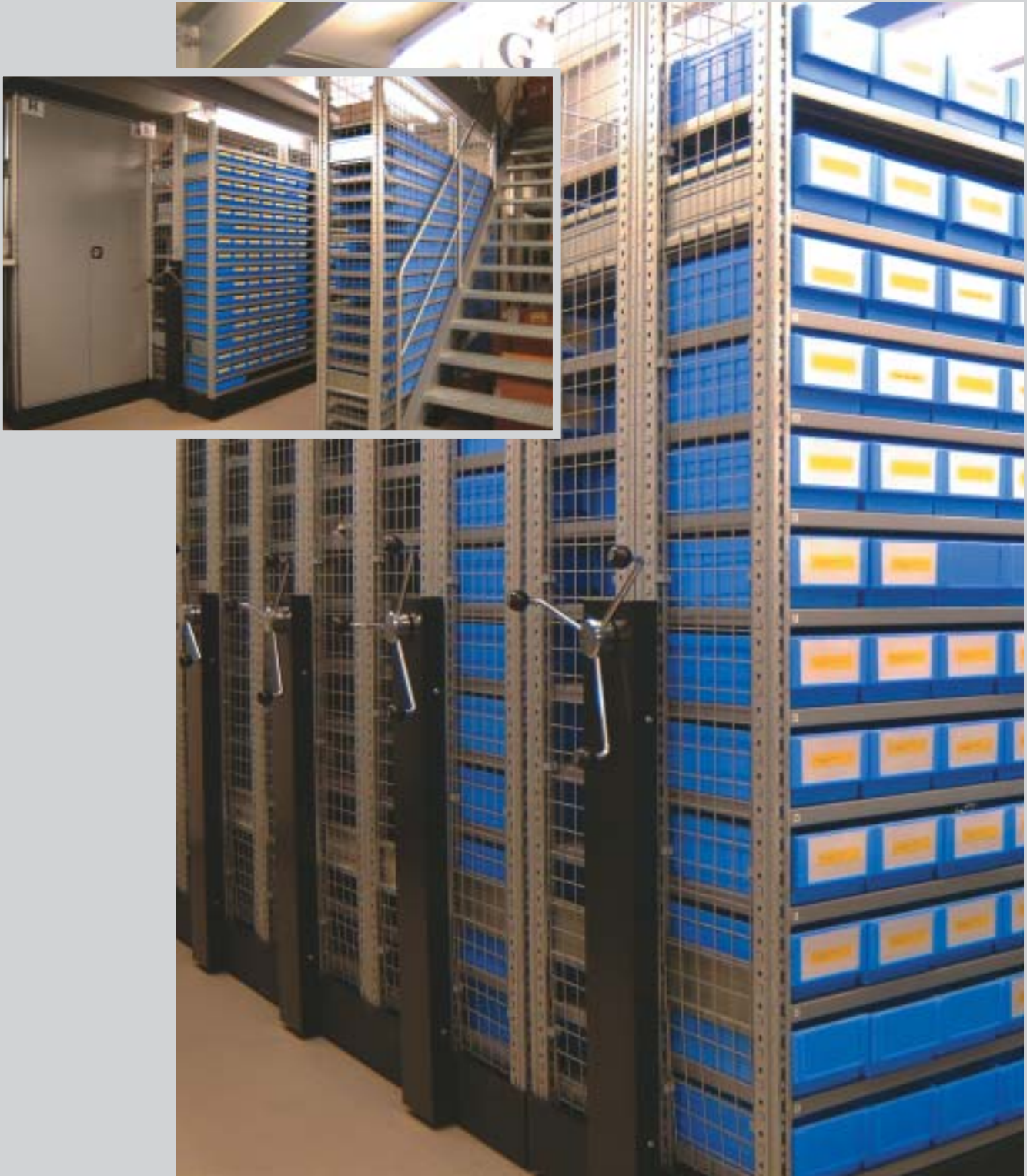
Példa kétszintes, mobil állványrendszerre. Az alsó szint apró alkatrészek tárolására szolgál. A felső szinten nagyméretű termékeket és gumiabroncsokat tárolnak.
